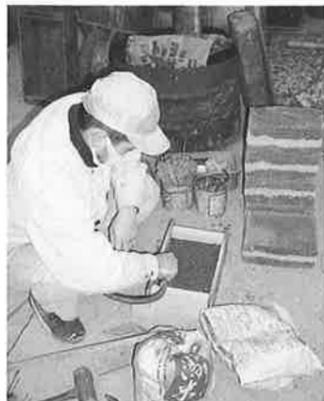
炭酸ガス法の型作り。珪酸ソーダを含む砂型に炭酸ガスを注入することで、焼かなくとも固めることができます。この製法で作業スピードが飛躍的に向上した。
